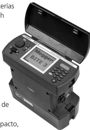
El BITE 3 es un instrumento compacto, operado a batería, con poderosas herramientas de análisis de datos incorporadas. Es el primer instrumento en su clase en que el ProActiv puede descargar todos los datos previos para proporcionar el mejor análisis de datos en sitio como ningún instrumento de su clase. Los menús son
